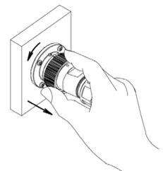
**結合していない状態でロックナットをロック方向に回転させないで下さい。**
